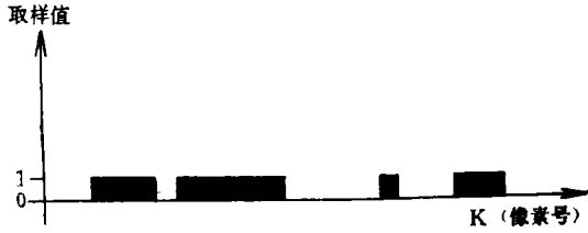
图 4 从图像的一边到另一边,沿直线的典型剖面图 (背景像素值为 0,边缘像素值为 1)
